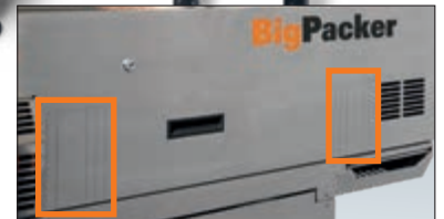
Vorstanzen für den Einsatz des Tintenstrahldruckers
