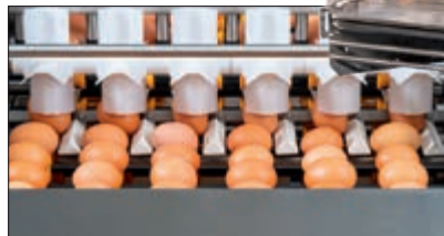
Ausgeklügte Technik sorgt dafür, dass alle Eier einheitlich ausgerichtet sind, bevor sie ins Karussell gehen
